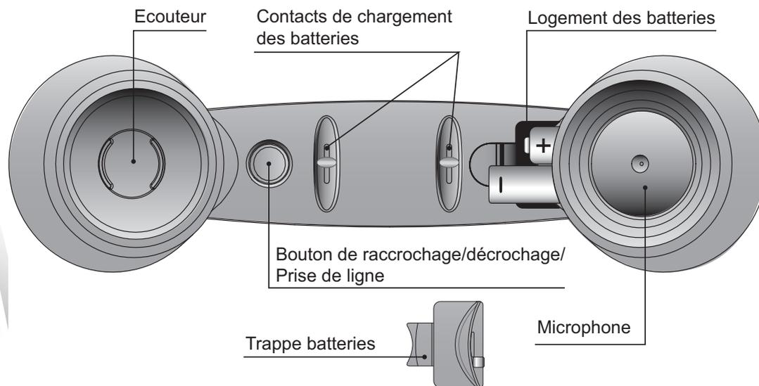
Les batteries du combiné se chargent quand celui-ci est posé sur sa base, le sens de positionnement sur la base n'a aucune importance. Le combiné sans fil hors base dispose d'une autonomie de 10 heures en communication et de 120 heures en veille.
