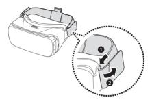
2 Fixez le bandeau sur le dessus du cadre frontal du Gear VR et tirez vers le haut jusqu'à ce qu'il s'enclenche.
