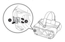
6 Branchez le connecteur à fonctions multiples de l'appareil mobile sur le connecteur.
