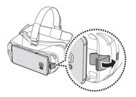
8 Insérez l'appareil mobile au centre du Gear VR (1) et poussez légèrement le porte-appareil (droit) vers la gauche jusqu'à ce l'appareil mobile soit parfaitement en place (2).
