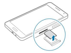
4 Insérez le compartiment de la carte SIM à l'endroit prévu à cet effet sur l'appareil.
