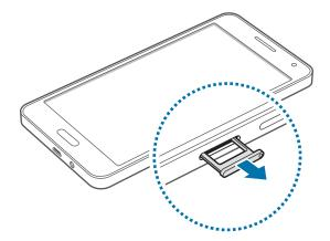
Modèles à deux cartes SIM: placez la carte SIM ou USIM sur le compartiment, puces orientées vers le bas.
