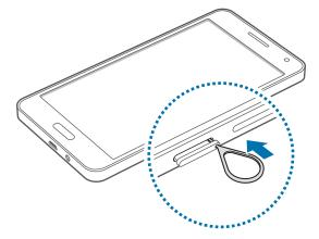
Vérifiez que l'outil de retrait est perpendiculaire à l'orifice. Dans le cas contraire, l'appareil pourrait être endommagé.
