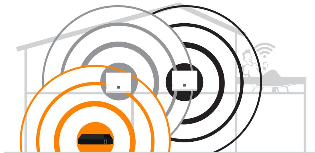
○ Wi-Fi de la Livebox   ○ Wi-Fi du répéteur Wi-Fi n°1   ○ Wi-Fi du répéteur Wi-Fi n°2
