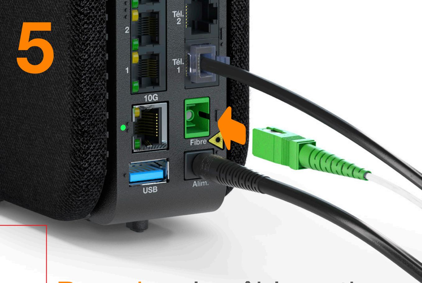
**Branchez** le câble optique à la prise « Fibre » verte de la Livebox.
