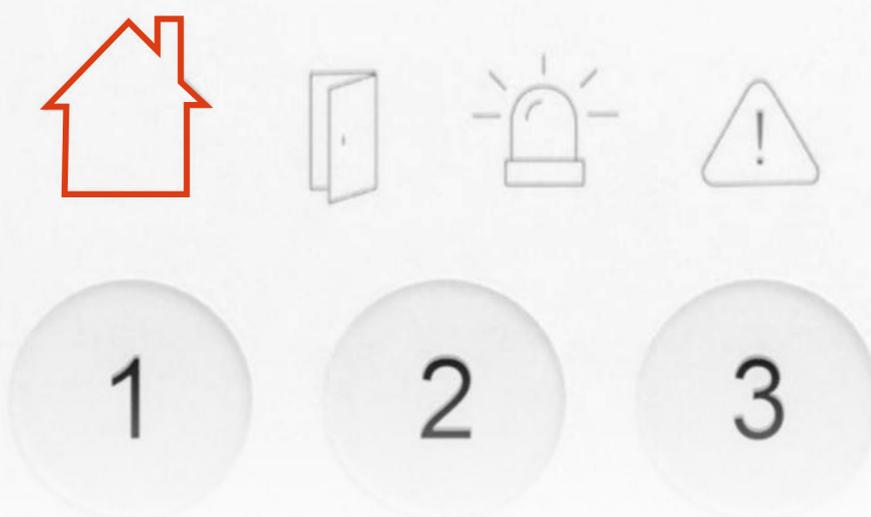
Le clavier émet des bips pendant le délai d'activation (30 secondes).
