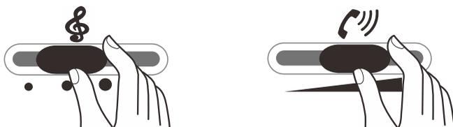
Le volume de réception dans le combiné peut alors être ajusté de 0 à 30dB. (lorsque l'amplification dépassera 15dB, l'information « **Mode amplifié** » sera affichée pendant 5 secondes).
