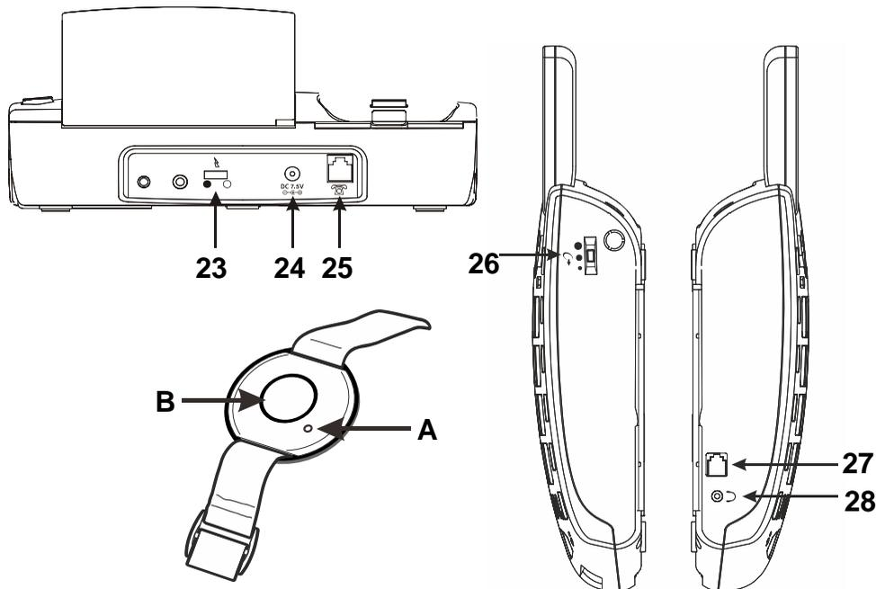
23. Interrupteur du flash lumineux de sonnerie
