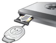
Introduzca la tarjeta SIM con los contactos dorados hacia arriba. Introduzca una tarjeta microSD opcional en la parte trasera de la bandeja.
