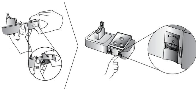
5. Déterminez la meilleure position de l'interrupteur. La tonalité d'appel doit être forte, nette et non déformée.
