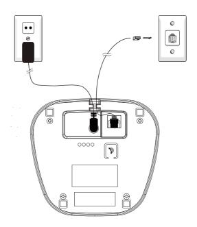
Si vous êtes connecté derrière une box ADSL, un filtre est nécessaire (il n'est pas fourni dans l'emballage).
