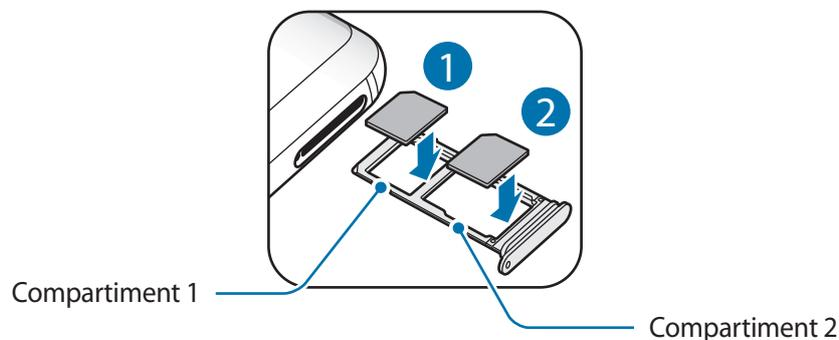
4 Appuyez légèrement sur la carte SIM ou USIM dans le compartiment afin de la mettre en place.
