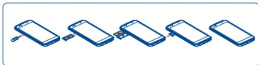
Avant de mettre en place ou de retirer la carte SIM/carte microSD, utilisez une épingle pour appuyer dans le petit orifice jusqu'à ce que le cadre de la carte SIM sorte.
