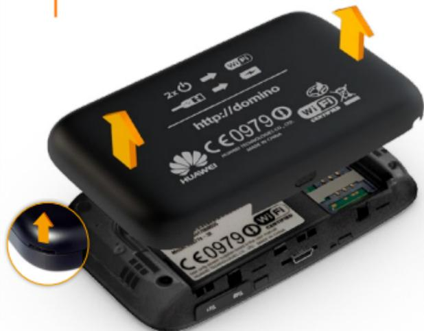
2 insérez la carte SIM dans le sens indiqué sur le schéma.
