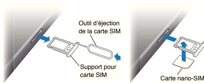
**Ouvrir le support pour carte SIM :** Insérez un outil d'éjection de carte SIM dans le trou du support pour carte SIM, puis appuyez fermement et poussez l'outil bien droit jusqu'à ce que le support sorte. Extrayez le support pour carte SIM pour installer ou remplacer la carte SIM. Si vous ne disposez pas de l'outil d'éjection de carte SIM, utilisez l'extrémité d'un trombone.
