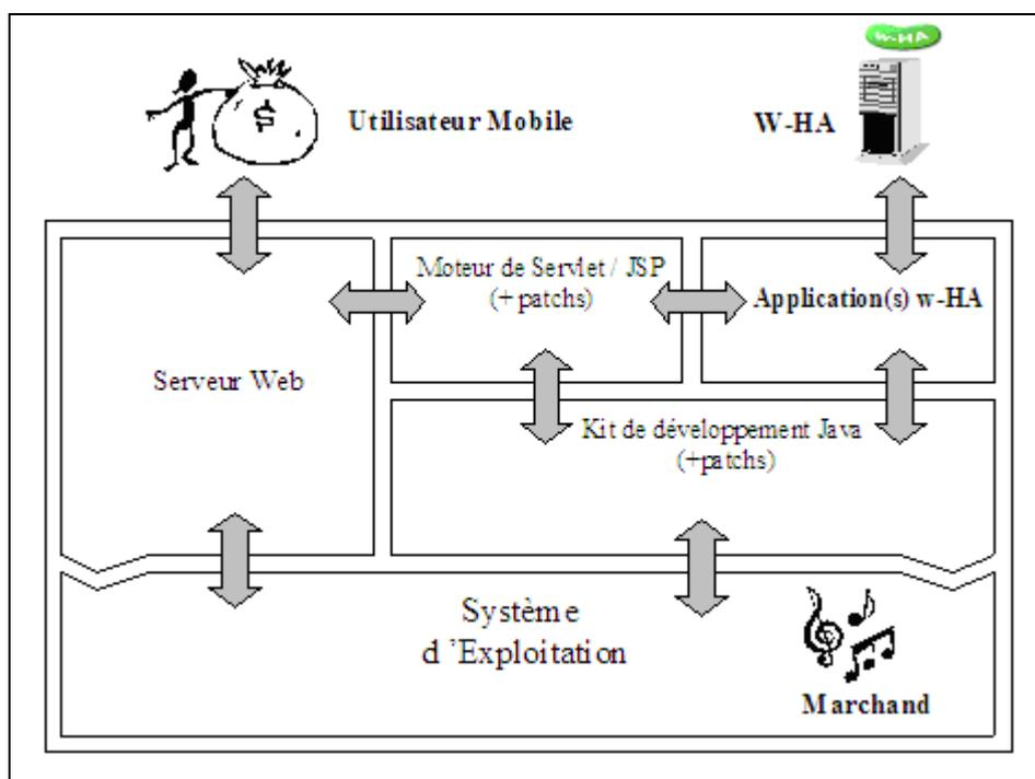
Figure 6 : composants nécessaires au KIT V3
